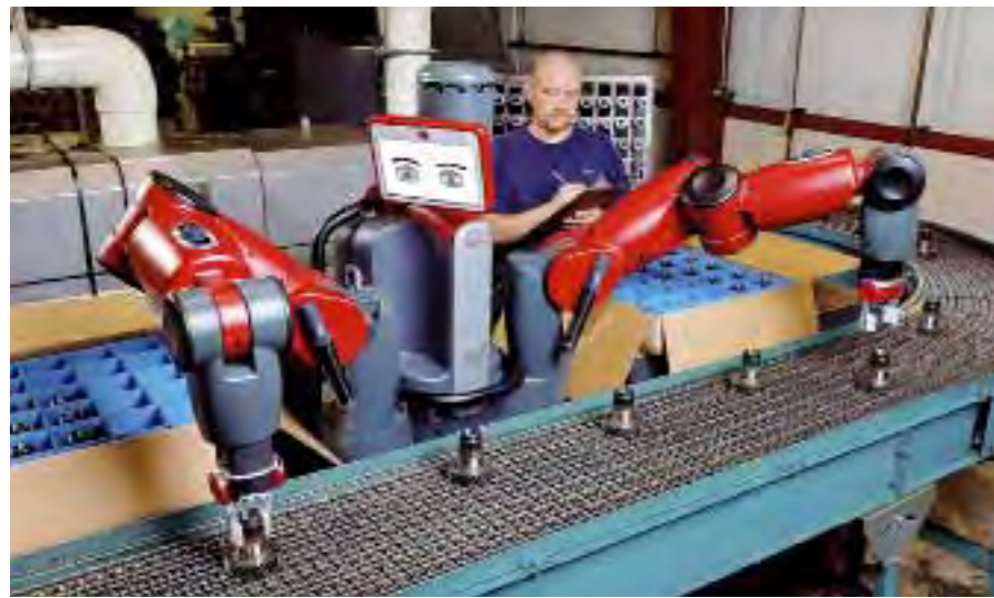
AIUTANTE. Il robot Baxter: i suoi bracci meccanici riescono a fare, in modo facile e veloce, azioni semplici e ripetitive in una catena di montaggio.
